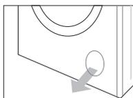
Desenchufe y abra la tapa usando un destornillador.
