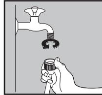
**Cuando hay una válvula de entrada en la parte trasera de la máquina, debe estar conectada a un suministro de agua fría.**
