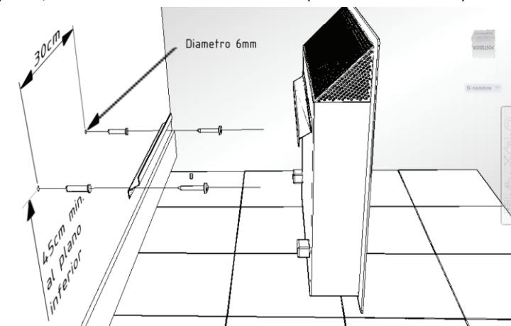
deben estar ajustados y firmes, a fin de garantizar la instalación segura del calefactor eléctrico.
